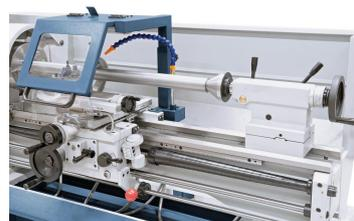
Zentrierkegel diam. 100 mm, ideal zum Spannen von Rohren und Hohlkörpern (Option).
