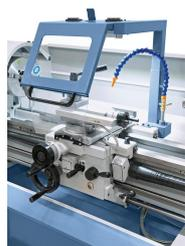
Integrierte LED-Maschinenlampe im Stahlhalterschutz für optimale Beleuchtung beim Arbeiten.
