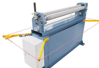
Erhöhte Sicherheit beim Arbeiten über Sicherheitsleine mit automatischer Abschaltung
