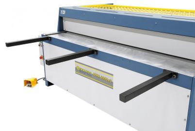
Die Auflagearme erleichtern das Bearbeiten großformatiger Bleche.
