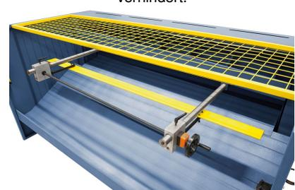
Robuster Hinteranschlag, einstellbar mittels Handrad.
