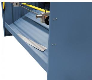
Auffangwanne für das Schnittgut an der Rückseite der Maschine.
