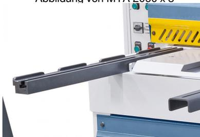
Exaktes Einstellen der Werkstücke durch seitliches Anschlaglineal.
