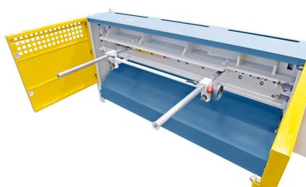
Exaktes Einstellen des Hinteranschlages mittels digitaler Anzeige.
