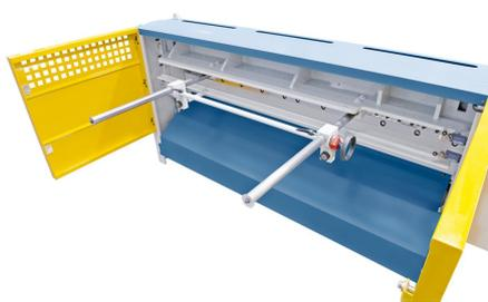
Exaktes Einstellen des Hinteranschlages mittels digitaler Anzeige.
