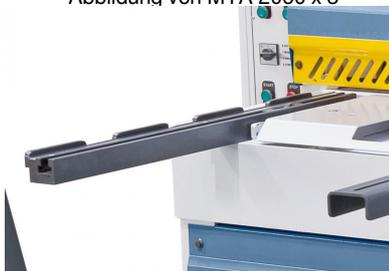
Exaktes Einstellen der Werkstücke durch seitliches Anschlaglineal.
