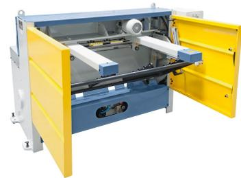
Rückwertige Maschinenansicht mit Schutzblech und Fotozellen.
