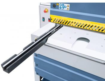
Seitliches Anschlaglineal mit Skala, Kippnocke und T-Nut.
