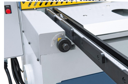
Schnelles und einfaches Einstellen des Schnittspaltes an der Vorderseite der Maschine.
