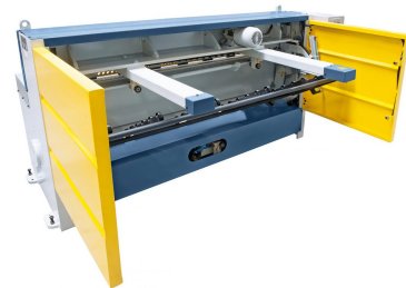
Rückwertige Maschinenansicht mit Schutzblech und Fotozellen.
