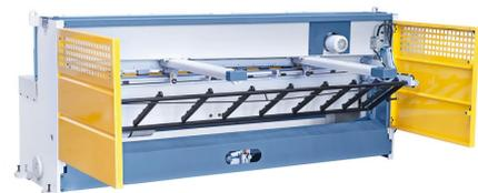
Rückwertige Maschinenansicht mit Schutzblech und Fotozellen.
