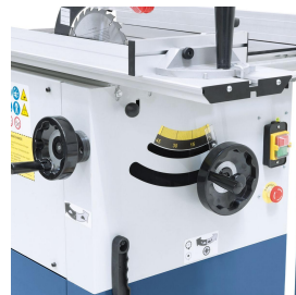
Die Höhenverstellung bzw. Schwenkung des Sägeaggregates erfolgt mittels ergonomisch angebrachten Handrädern.
