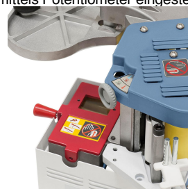
Die gewünschte Arbeitstemperatur wird mittels Potentiometer eingestellt.
