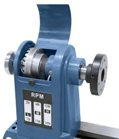
Einfaches Wechseln der Übersetzungsstufe durch Umlegen des Keilriemens.
