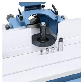
Die Wechselspindel ermöglicht eine enorme Zeitersparnis bei Serienfräsarbeiten.
