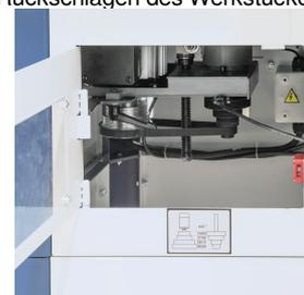
Schnelles und einfaches Wechseln der Drehzahl mittels Keilriemen.
