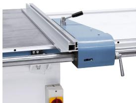
Der Parallelanschlag mit stabiler Rundstangenführung ist für Schnittbreiten bis 1300 mm verwendbar.
