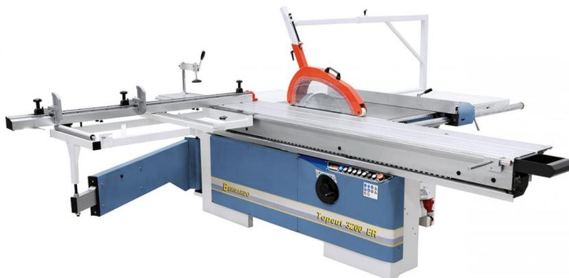
Die Präzisions-Formatkreissäge Topcut 3200 ER ist für den professionellen Anwender bestens geeignet. Der verwindungssteife Maschinenkörper aus einer Stahl- Graugusskombination sowie das stabile Sägeaggregat mit dem starken Antriebsmotor gewährleisten einen vibrationsfreien Lauf und eine gleich bleibende Schnittgeschwindigkeit. Zusätzlich ist dieses Modell mit einer elektronischen Sägeblatt Höhenverstellung sowie einer digitalen Schnitthöhenanzeige ausgestattet.
