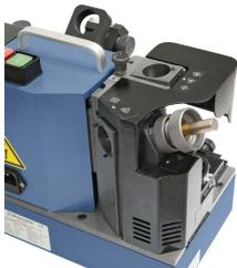
Schleifen des Freiwinkels bei 2-schneidigem Fräser
