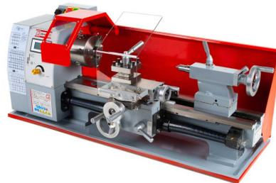
Die HOLZMANN ED400FD\_230V ist eine kompakte Tischdrehmaschine für die Bearbeitung von Stahl, Guss, NE-Metallen, Alu, Messing und Kunststoffen. Mit einer Spitzenweite von 400 mm können mit ihr auch längere Werkstücke bearbeitet werden. Die Prismenbettführung ist induktiv gehärtet und präzisionsgeschliffen. Hohe Rundlaufgenauigkeit und hochwertige Bauweise ergeben eine kompakte und durchzugsstarke Drehbank für den ambitionierten Metallbearbeiter.
