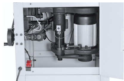
Das Fräsaggregat aus Grauguss ist leicht zugänglich, wodurch ein problemloser Drehzahlwechsel möglich ist.
