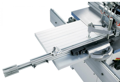
Durch den optionalen Rolltisch mit ausziehbarem Teleskopanschlag und Exzenterspanner wird der Einsatzbereich
