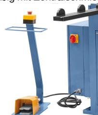
Bedienung mittels Fußpedal, daher beide Hände frei für das Werkstück.
