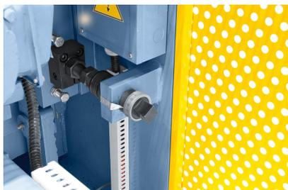
Leichtes Einstellen des Schnittspaltes auf die jeweilige Blechstärke an der Rückseite der Maschine.
