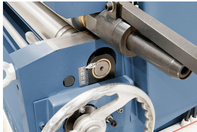
Exaktes Zustellen der Unterwalze mittels Skala.
