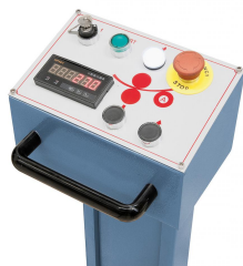
Übersichtliches Bedienpaneel, Zustellung der Hinterwalze erfolgt motorisch, Einstellung über Digitalanzeige ablesbar (Standard).
