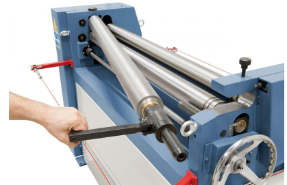
Zustellung der Unterwalze mittels Handrad, Oberwalze nach vorne ausschwenkbar.
