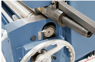
Exaktes Zustellen der Unterwalze mittels Skala.
