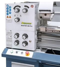
Übersichtlich angebrachte Schaltelemente am Getriebekopf, gehärtete und geschliffene Zahnräder sorgen für einen ruhigen Lauf.
