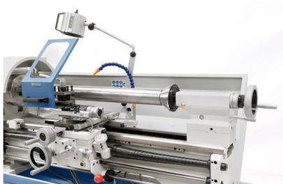
Zentrierkegel diam. 125 mm, ideal zum Spannen von Rohren und Hohlkörpern (Option).
