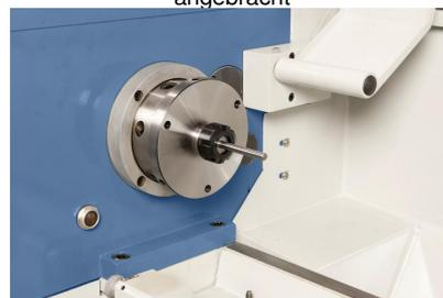
Das Spannzangenfutter ER 25 gewährleistet eine hohe Rundlaufgenauigkeit beim Spannen von Werkstücken, Spannbereich 1 - 16 mm
