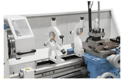
Zum Stabilisieren von langen Werkstücken serienmäßig mit einer feststehenden bzw. mitlaufenden Lünette ausgestattet.
