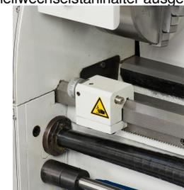
Serienmäßig mit Rutschkupplung und Mikrometerlängsanschlag ausgestattet
