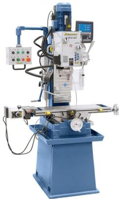
Die Bohr- und Fräsmaschine FM 55 HSV überzeugt durch ihre stabile Konstruktion und einfache Handhabung. Schon die Grundausstattung beinhaltet alle wichtigen Zubehöre (3-Achs-Digitalanzeige, Frästisch- vorschub, Hubmotor, Zentralschmierung, Kühlmittleinrichtung, LED-Arbeitsleuchte, Graugussuntergestell mit Kühlmittelrinne, Sicherheitseinrichtungen nach CE-Norm, ...), wodurch diese Maschine universell einsetzbar ist.
