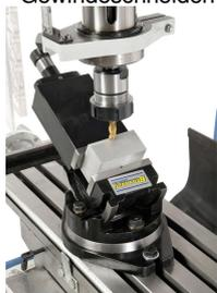
Fräsen mit 2-Achs-Schraubstock
