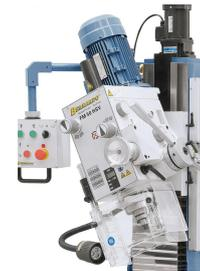
Beidseitig schwenkbarer Fräskopf von -60° bis +60°.
