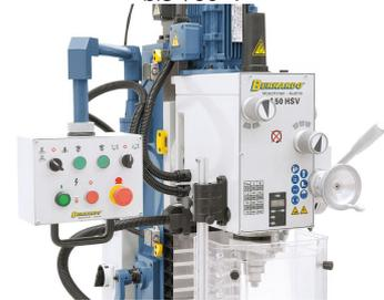
Einfacher und schneller Drehzahlwechsel mittels Getriebewahlschalter.
