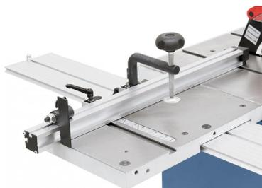
Der Rolltisch aus Grauguss ist plangenau bearbeitet und geschliffen.
