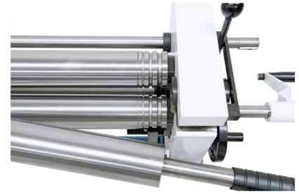
Zur Entnahme des fertigen Werkstückes wird die Oberwalze ausgeschwenkt.
