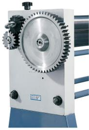
Der Antrieb der Walzen erfolgt über ein massives Zahnradgetriebe.
