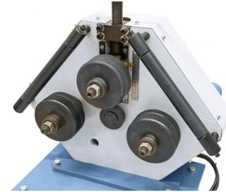
Die Einstellung der Oberwalze wird über eine mm-Skala abgelesen.
