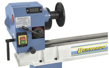
Für ein optimales Einstellen der gewünschten Drehzahl ist die Maschine mit einer digitalen Drehzahlanzeige ausgestattet.
