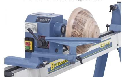
Zum Bearbeiten größerer Werkstücke kann der Spindelkopf um 90° geschwenkt werden
