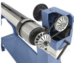
Die Geschwindigkeitsübertragung vom Motor zur Pinole erfolgt über einen soliden Variatorantrieb
