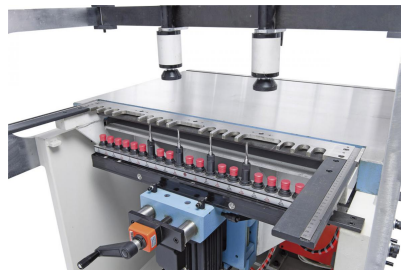
Anschlagfingerleiste mit 3 Aussparungen zur Verwendung von Kombiboehrsegmenten für Topfbänder
