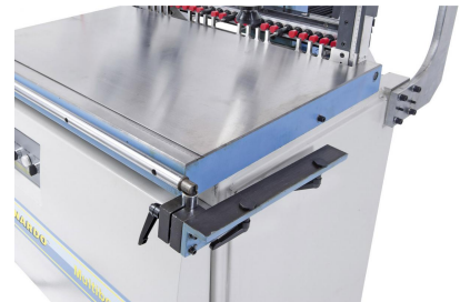
Abschwenkbare Seitenanschlüsse für kurze Umrüstung von Korpus- auf Rahmen- und Lochreihenbohrungen
