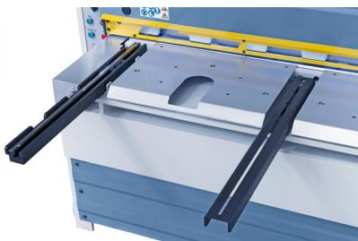
Exaktes Einstellen der Werkstücke durch seitliches Anschlaglineal.
