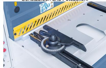
Der optionale Winkelanschlag ermöglicht das Schneiden von Gehrungen.
