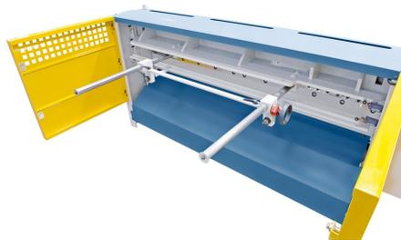
Exaktes Einstellen des Hinteranschlages mittels digitaler Anzeige.
