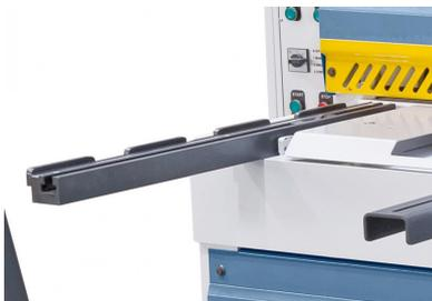
Exaktes Einstellen der Werkstücke durch seitliches Anschlaglineal.
