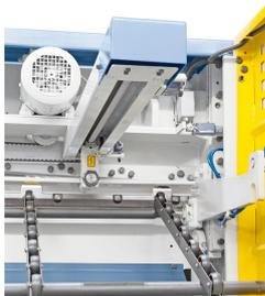
Hinteranschlag mit Kugelumlaufspindel für erhöhte Genauigkeit.
