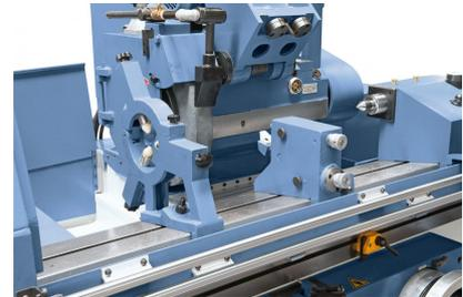
Zum Stabilisieren von langen Werkstücken serienmäßig mit einer geschlossenen bzw. 2 offenen Lünetten ausgestattet.
