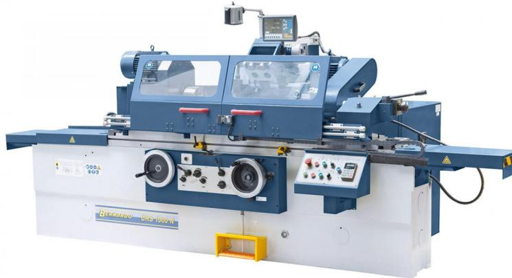
Die Universal-Rundschleifmaschine URS 1000 N eignet sich zur Ausführung von Außenrundschleifarbeiten für Werkstücke bis 320 mm Durchmesser, durch die serienmäßige Innenschleifeinrichtung wird der Anwendungsbereich zusätzlich erweitert. Ihren Einsatzbereich finden diese Modelle hauptsächlich im Maschinenbau, im Formen- und Werkzeugbau, aber auch bei der Kleinserienfertigung in der Produktion.
