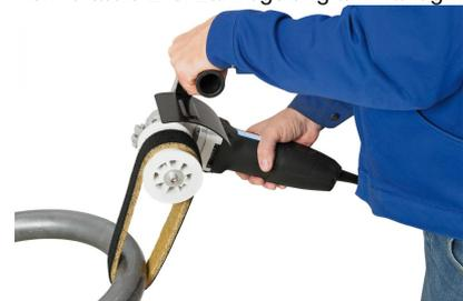
Optional mit Klettvlies zum Nachbearbeiten von bereits montierten Edelstahlgeländern.
