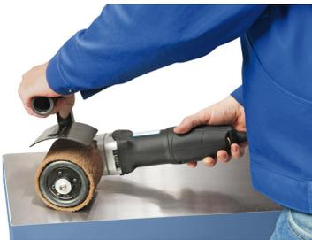
Optional mit Gummiluftrolle, der Luftpolster passt sich an die Oberfläche des Werkstückes an.
