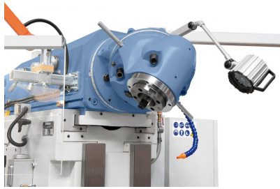
Durch die Verstellung der 90° und 45° Ebene kann der Universalschwenkkopf auf sämtliche Winkelpositionen eingestellt werden.
