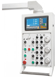
Übersichtlich aufgebautes Bedienpaneel mit integrierter Digitalanzeige und elektronischen Handrädern.
