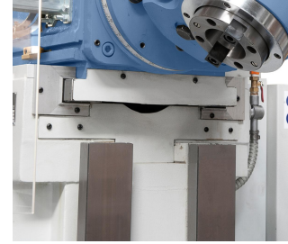
Großdimensionierte Rechteckführung in y- und z-Achse gewährleistet eine hohe Stabilität.
