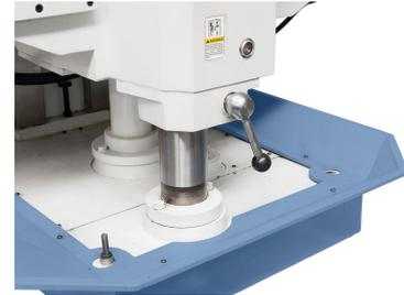
Manuelle Klemmung der z-Achse für erhöhte Stabilität.
