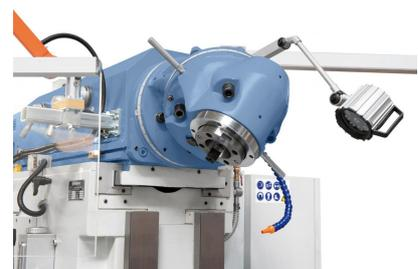
Durch die Verstellung der 90° und 45° Ebene kann der Universalschwenkkopf auf sämtliche Winkelpositionen eingestellt werden.
