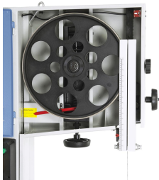
Das Antriebsrad mit Spezialgummibandage sorgt für einen ruhigen Lauf und erhöht die Lebensdauer des Sägebandes
