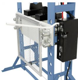
Der Kolbenhub erfolgt wahlweise mittels Handhebel (2 Stufen) oder pneumatisch mittels Fußpedal
