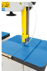
Kugelgelagerte Sägebandführung, einstellbar auf die jeweilige Werkstückhöhe.
