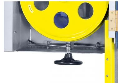
Die Einstellung der Blattspannung erfolgt mittels Handrad.
