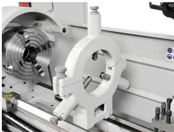
Feststehende Lünette zum Abstützen von langen und dünnen Werkstücken.
