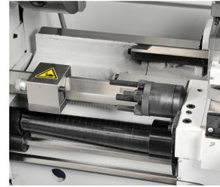
Mikrometerlängs- und Revolveranschlag im Lieferumfang enthalten.
