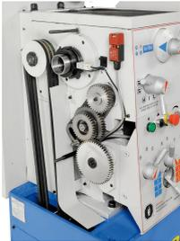
Serienmäßig ausgestattet mit Wechselrädern zum Gewindeschneiden.
