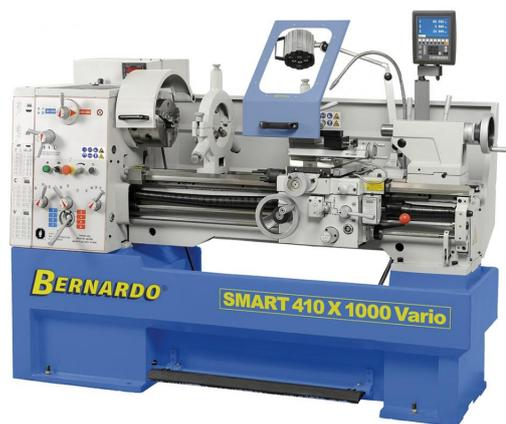
Die Universal Drehmaschine Smart 410 Vario eignet sich zur Ausführung von leichten und mittelschweren Dreharbeiten. Schon die Grundausstattung beinhaltet alle wichtigen Zubehöre (3-Backenfutter, Lünetten, Wechselräder, 3-Achs-Positionsanzeige,...) wodurch diese Maschine universell einsetzbar ist. Weiters ist dieses Modell mit einer stufenlos regelbaren Spindeldrehzahl bis 3000 U/min ausgestattet, dadurch kann die Drehzahl optimal an das Werkstück und die Vorschubgeschwindigkeit angepasst werden.
