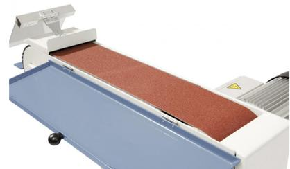
Große Schleiffläche durch wegklappbare Abdeckung.
