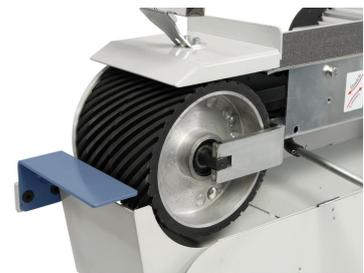
Kontaktrolle 70° - 74° Shore A, optimal für Schruppbearbeitung
