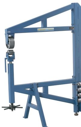
**Bernardo RSM 1040 Rollenstreckmaschinen** sind ideal zur Herstellung von Kotflügeln, Türen, Hauben usw. bei der Restauration von Oldtimern. Die Maschinen bieten eine einfache Entnahme des fertigen Werkstücks durch Schnellhebemechanismus an der unteren Formrolle und einen einfach einstellbaren Pressdruck mittels Handrad für den perfekten Radius.
