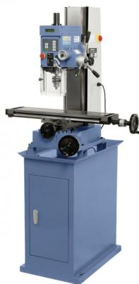
Die Bohr- und Fräsmaschine BF 25 L Super besticht durch ihren hohen Verarbeitungsgrad sowie einigen interessanten Innovationen (u. a. Gleichstromantrieb, Bedienung über Folientastatur). Ihren Einsatzbereich findet diese Maschine beim professionellen Anwender, im Modellbau, aber auch im Ausbildungsbereich wird sie sehr gerne eingesetzt. Zusätzlich zeichnet sich dieses Modell durch den größeren Arbeitstisch und den längeren Verfahrweg in der x-Achse aus.
