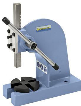
Die Bernardo DP 2 Drehdornpressen ist eine professionelle Lösung zum Ein- und Auspressen von Lagern, Buchsen und anderen Teilen. Die verwindungsfreie Stahlkonstruktion sorgt für eine hohe Stabilität und Präzision. Die Maschine ist inklusive Montagebohrungen, ideal zum Befestigen auf einer Werkbank, und verfügt über eine variabel einstellbare Hebelstange, je nach erforderlichen Kraftaufwand.
