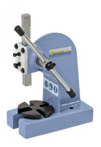
Die Bernardo DP 1 Drehdornpressen ist ideal für das Ein- und Auspressen von Lagern, Buchsen und anderen Teilen. Sie ist in verwindungsfreier Stahlkonstruktion ausgeführt und verfügt über Montagebohrungen, um sie ideal auf einer Werkbank zu befestigen. Die variabel einstellbare Hebelstange ermöglicht es, den Kraftaufwand je nach Anforderung anzupassen.
